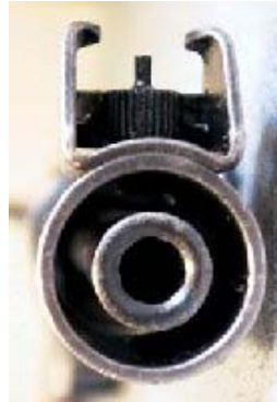
Fullt nedskruvat korn på kpist m/45B d.v.s. ” in- och uttryckningsläge”
