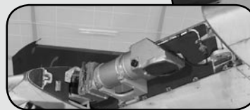
S 35E i helfigur och delfigur som visar öppningarna för kameror och sikte i nosen.
