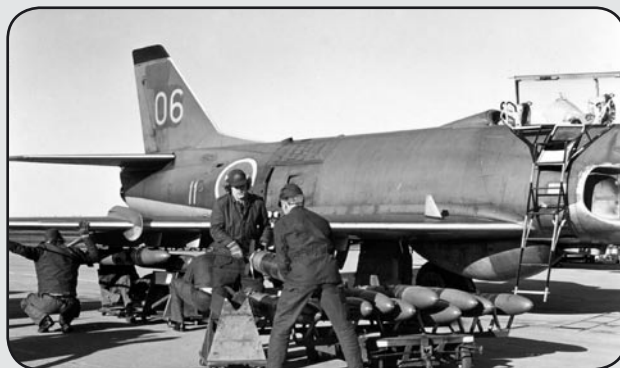
Hängning av fotobomber på S32. Flygplanet kunde bära 12 st fotobomber m/62, som fungerade som blixtaggregat vid fotografering under mörker med Ska23-kamerorna. Foto 1978.
